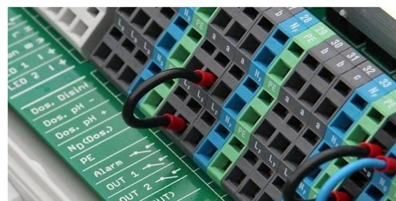
Drahtbrücke im Klemmraum von der Phase L<sub>F</sub> auf den Mittelkontakt a
