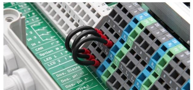
Drahtbrücken im Klemmraum von der Phase L<sub>D</sub> auf die Mittelkontakte a der Dosierausgänge
