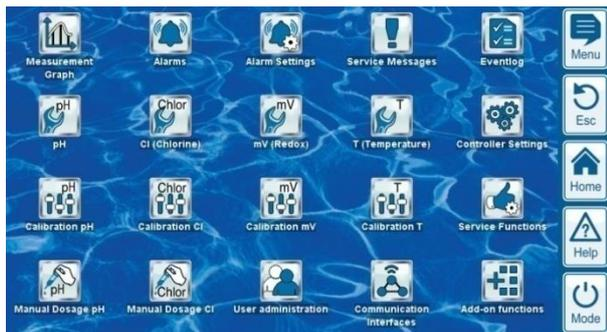
Die Anzeige und Bedienung erfolgen auf einem großen TFT-Farb-Display mit Touchscreen. Jede angezeigte Funktion kann durch einfaches Tippen mit dem Finger auf den entsprechenden Bildschirm-Bereich ausgeführt werden. Jedes Tippen auf den Touchscreen wird durch einen Signalton bestätigt.
