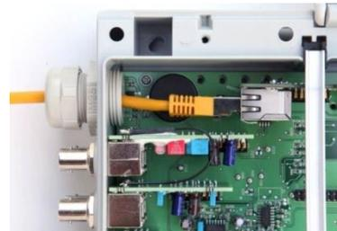
9. Schrauben Sie die Kabelverschraubung wieder gut fest, um eine zuverlässige Abdichtung zu erzielen.
