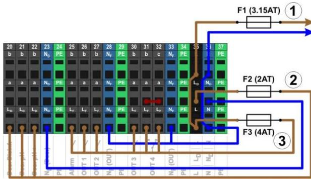
Die Versorgung für das Analyt Gerät sowie für das Alarm-Relais und die Zusatz-Funktionen teilen sich einen gemeinsamen Netzeingang (L/N). Die Phase L für den Analyt wird vom Eingang über die Sicherung F1 geführt. Die Phase L<sub>F</sub> für das Alarm-Relais und die Zusatz-Funktionen wird vom Eingang über die Sicherung F3 geführt. Die Nullleiter N und N<sub>F</sub> sind intern miteinander verbunden.
